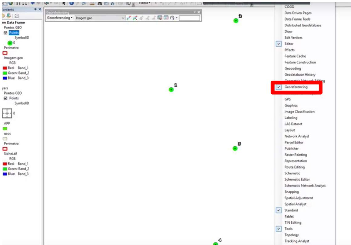
Antes de começarmos a associação dos pontos de controle a suas respectivas posições na imagem precisaremos desmarcar a opção “*Auto ajuste*” pois senão a cada ponto que informarmos a imagem irá automaticamente se ajustar. Para isso proceda conforme é mostrado na imagem abaixo.
